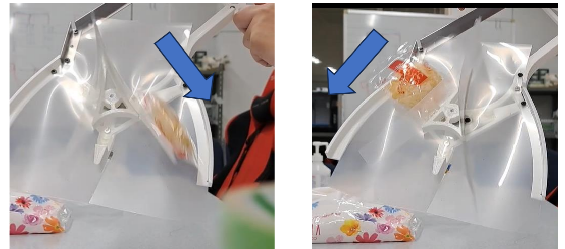
図3 整理機構の実際の画像とワークの動き
